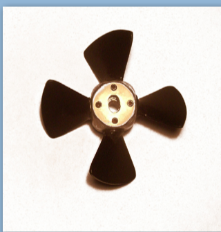
Figuur 3 Gefabriceerde modelschaal schroef
