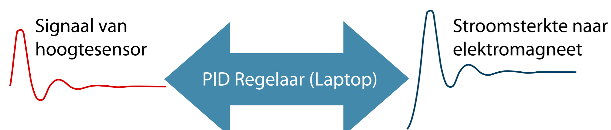
Schematische weergave van de werking van het actief geregeld luchtlager.
