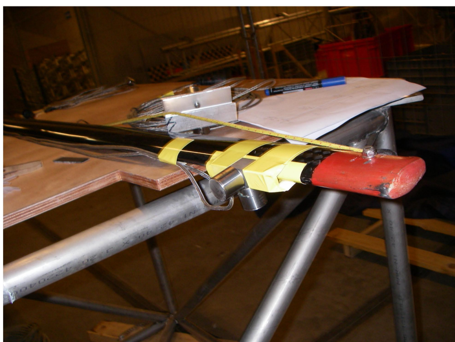
Versnellingsmeters die in de x en y richting meten, op de top van de mast
