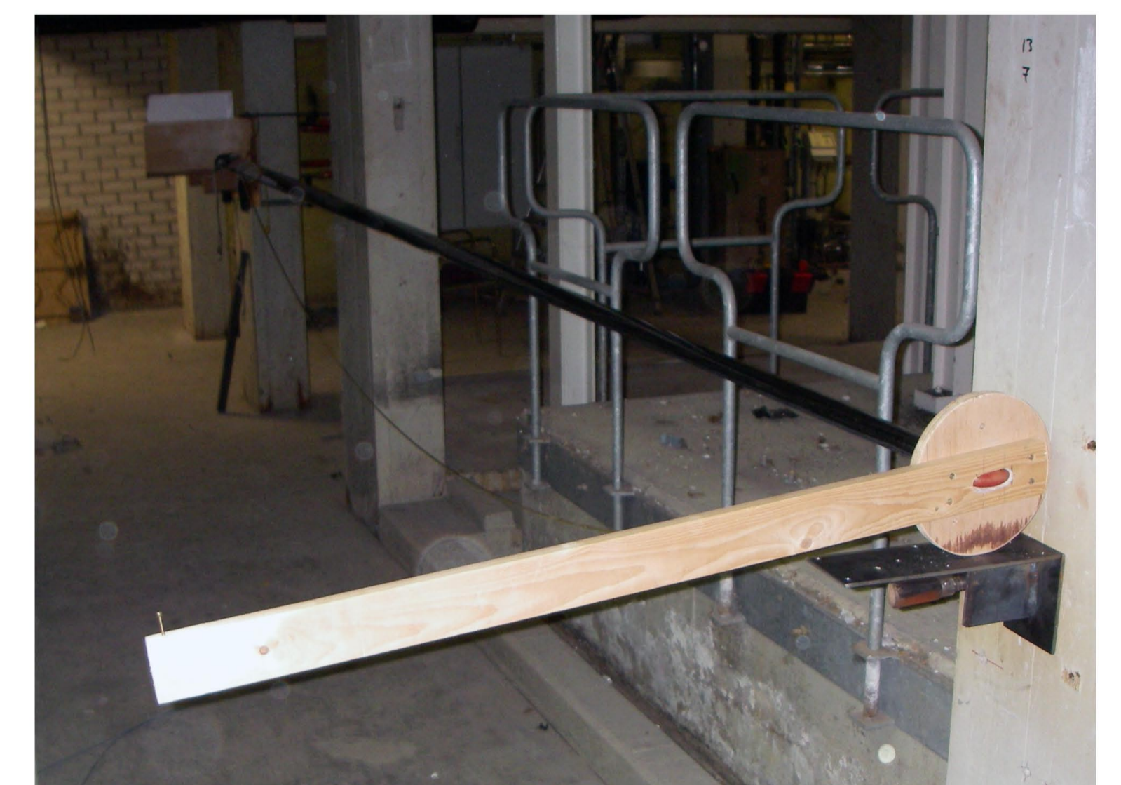
De meetopstelling voor de torsiestijfheid in de catacomben van de TU Delft
