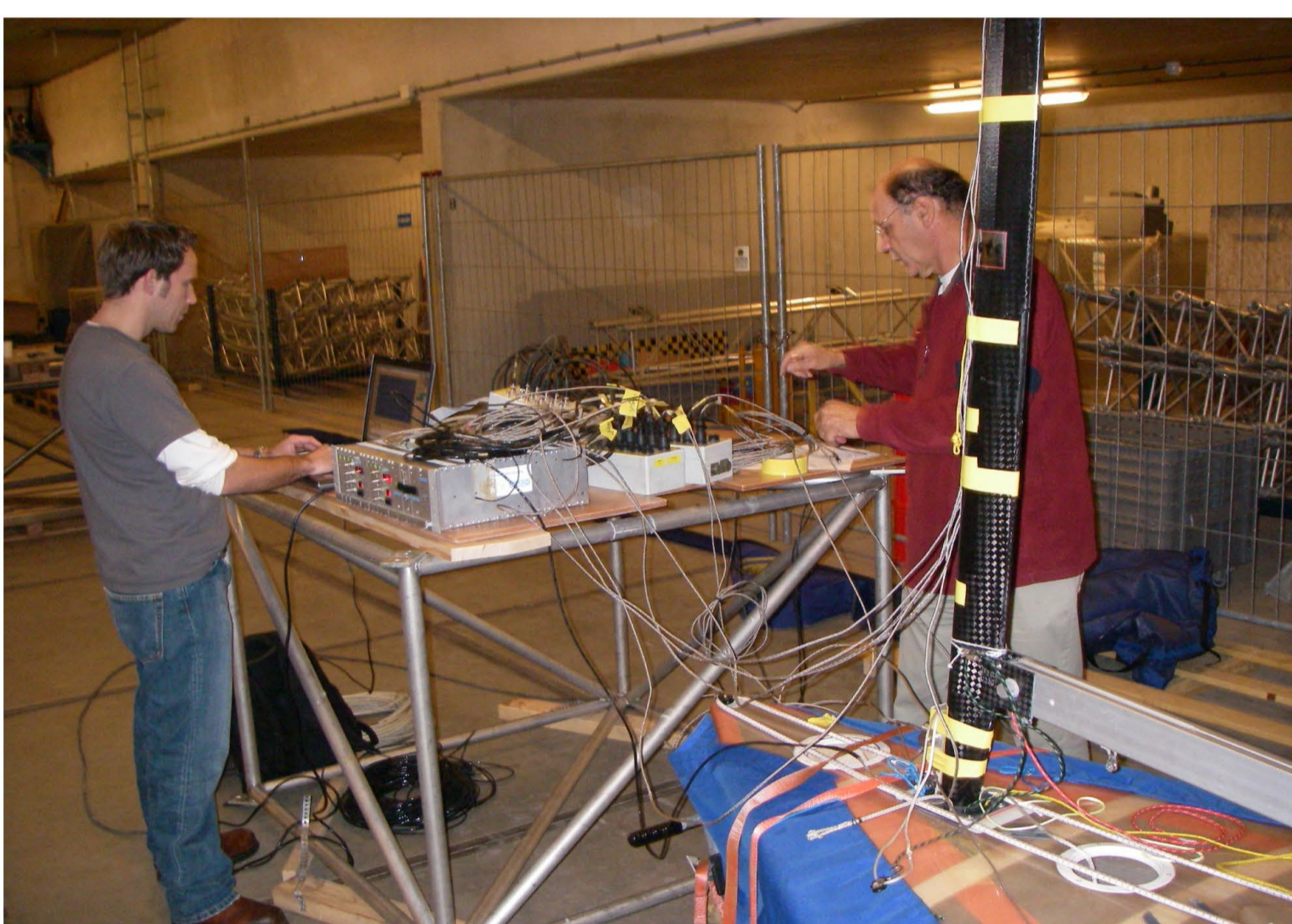
De onderzoekopstelling bij het MARIN: een ingeklemde mast vol sensoren
